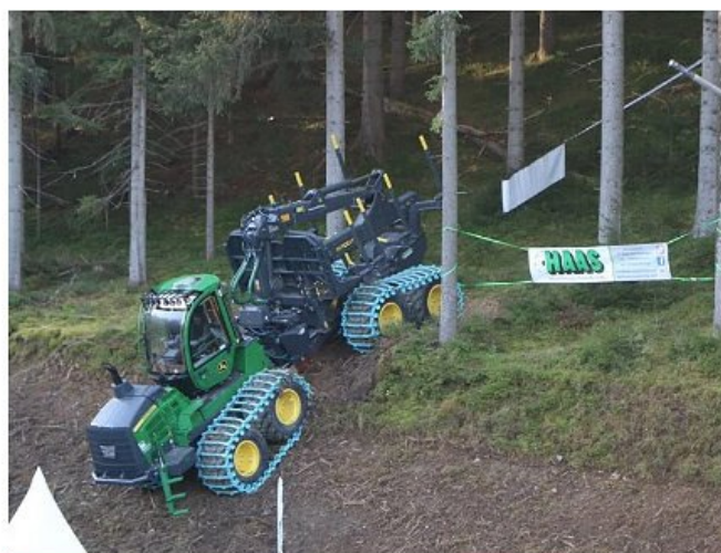
Slika 10: Pomožni vitli pasivnega sistema proizvajalca Haas Maschinenbau GmbH & Co. KG na primeru zgibnega polprikolčarja John deere. (foto: M. Dolensek)
