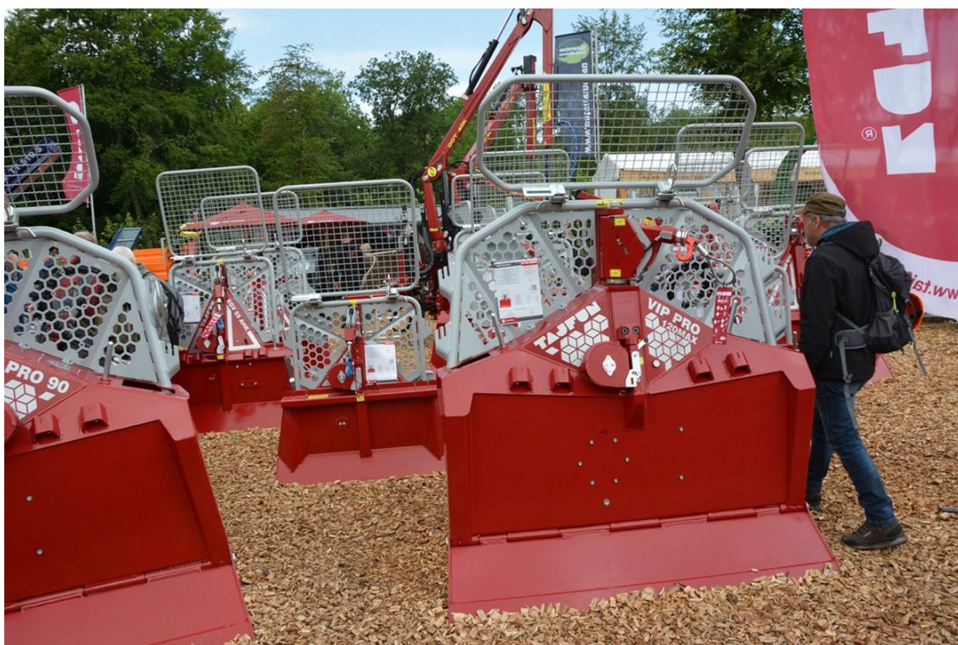
Slika 16: Tajfun nudi širok izbor gozdarskih vitlov. Posebna pozornost je bila namenjena vitlu VIP PRO 120 MAX s konstantno vlečno silo.
