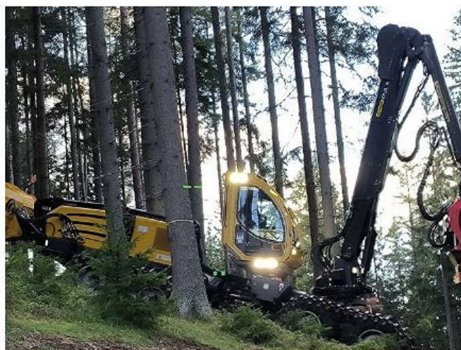
Slika 14: Pasivni »winch assisted« sistem proizvajalca HSM (Hohenloher Spezial-Maschinenbau GmbH) kot dodatna oprema na zadnjem delu stroja za sečnjo (foto: M. Jež)
