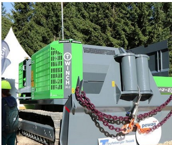
Slika 11: Največji T-winch s konstantno vlečno silo 180 kN in maso 33 t (foto: M. Dolenšek)
