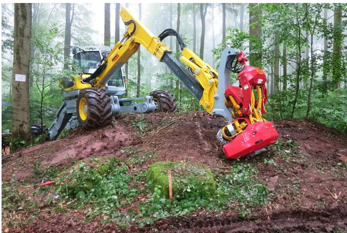
Slika 6: Koračni bager je z ustrežno opremo uporaben tudi v gozdarstvu. Z njim je mogoče mehanizirano spravilo lesa na težko dostopnih terenih.
