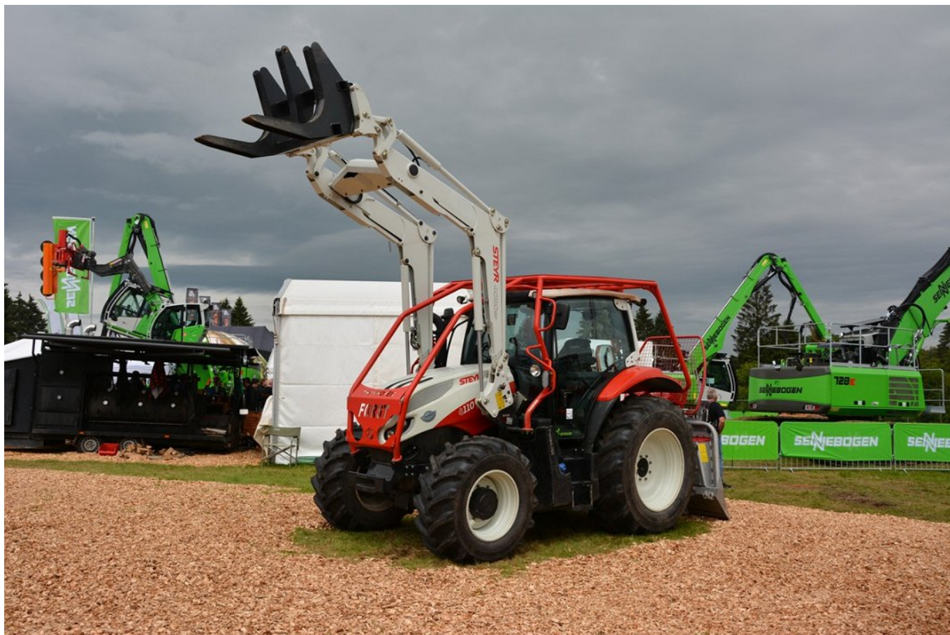
Slika 4: Tipični kmetijski traktor z gozdarsko nadgradnjo in opremo. Nadgradnje izdelujejo specializirana podjetja.
