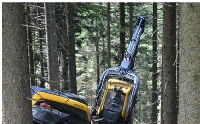
Slika 7: Na fotografiji lahko vidimo da mehanizem niveliranja kabine in dvigala ne uspe kompenzirati naklona terena (kabina in roka dvigala nista v horizontalni oz. vertikalni poziciji), saj je naklon večji od 15° oz. 27%, kar je maksimalna zmogljivost niveliranja za model Ponsse Scorpion. (Foto: M. Jež)
