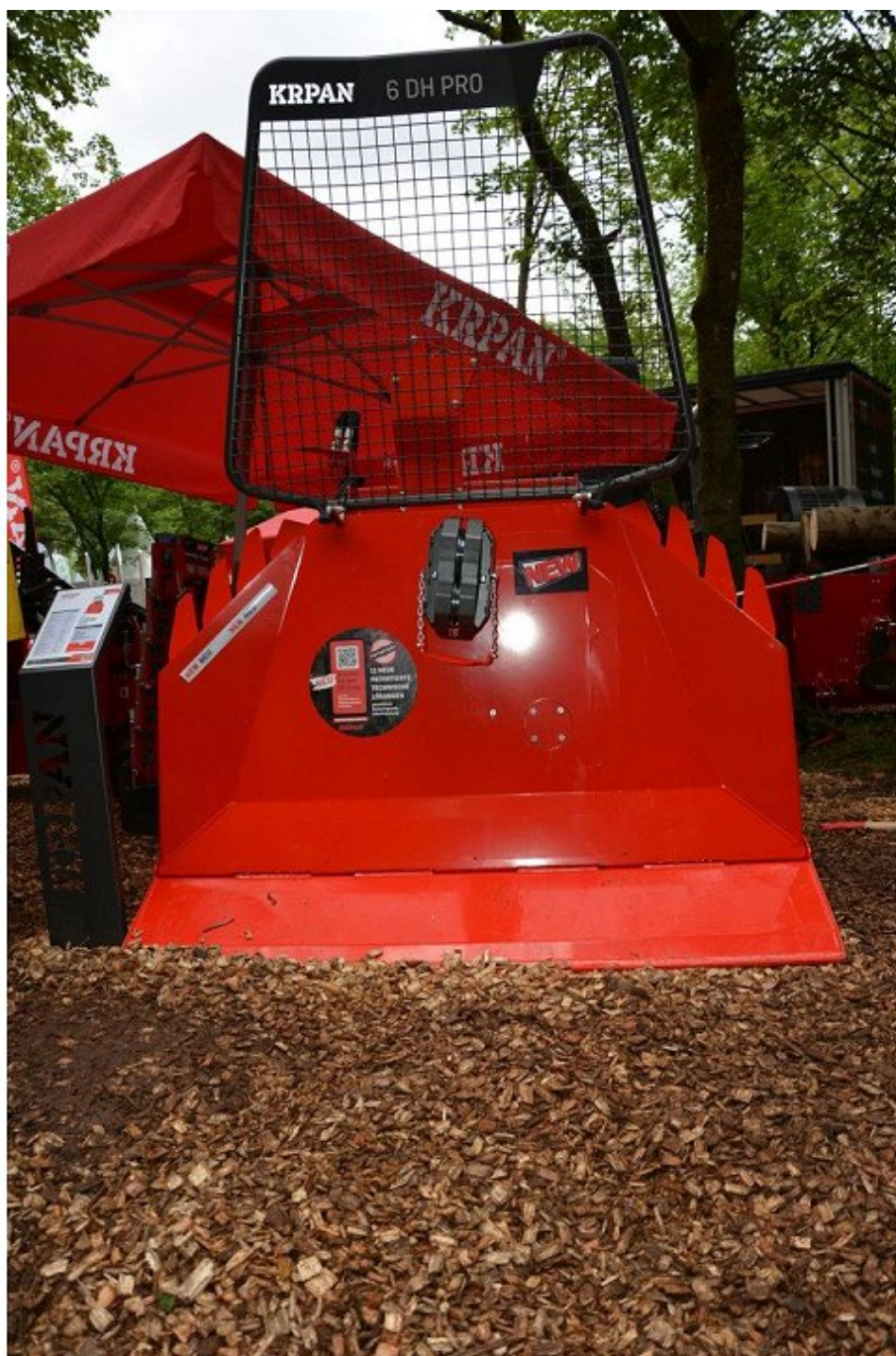
Slika 11: Nov Krpanov vitel s konstantno vlečno silo ima vlečno maso 5,5 ton.
