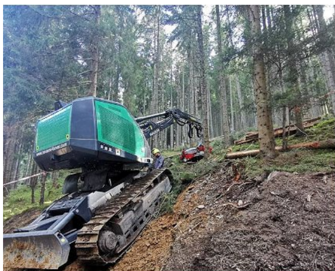
Slika 9: Gosenični stroji za sečnjo imajo kot niveliranja naprej zelo velik (za model znamke Neuson znaša 25° oz. 47 %). (foto: V. Kavčič)
