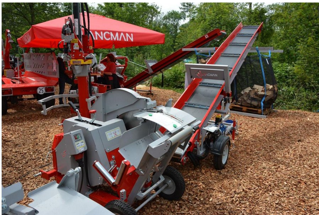
Slika 13: Novi mobilni Lancmanov transportni trak je mogoče uporabljati tudi z dosedanjimi modeli prevesnih krožnih žag.
