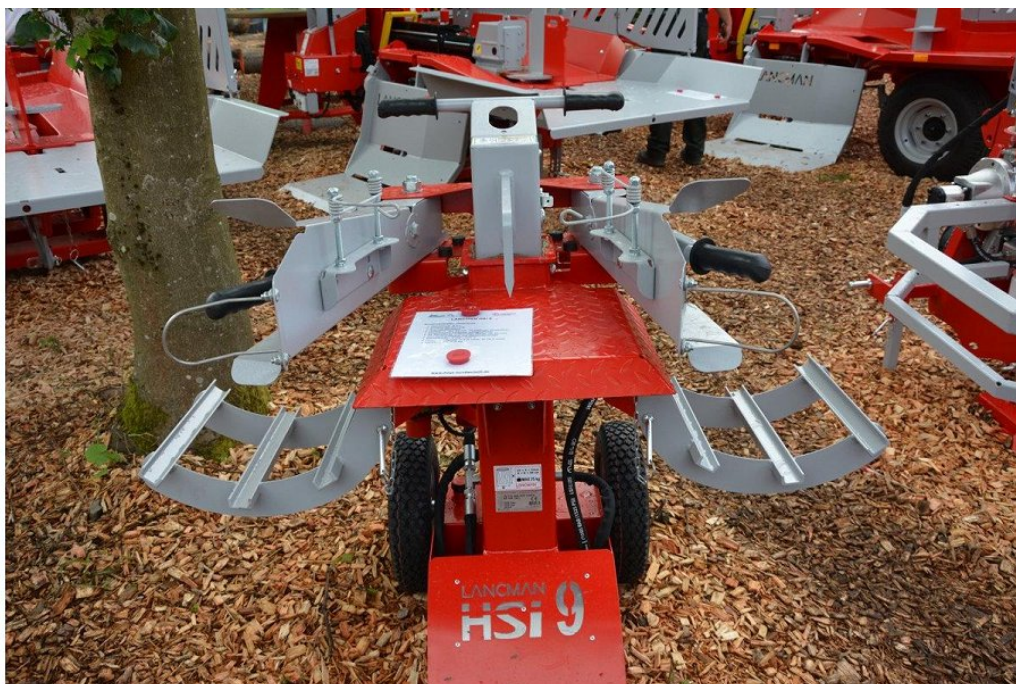
Slika 12: Lancmanov cepilnik za kratek les z 9 tonami cepilne mase.
