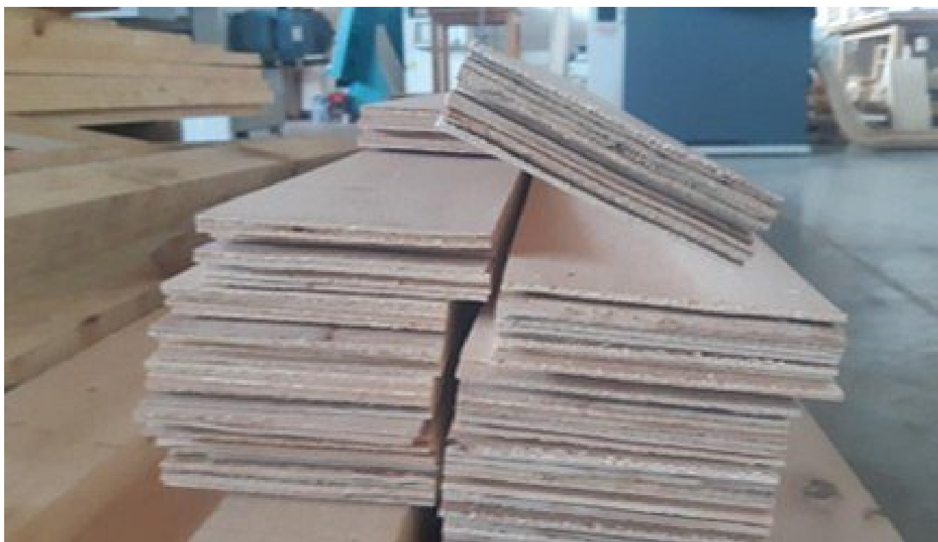
Slika 8: Celi nosilci iz slojnatega furnirnega lesa dimenzij 125 x 30 x 2500.
