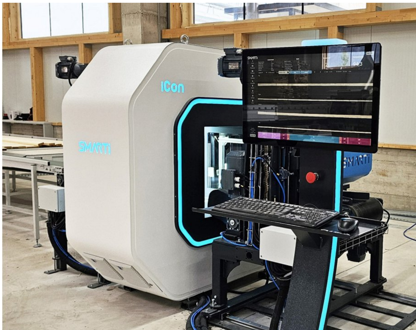
Slika 6: Visokokakovostni vmesnik na proizvodni liniji namenjen štiristranskemu 3D skeniranju desk za razvrščanje v proizvodnih procesih
