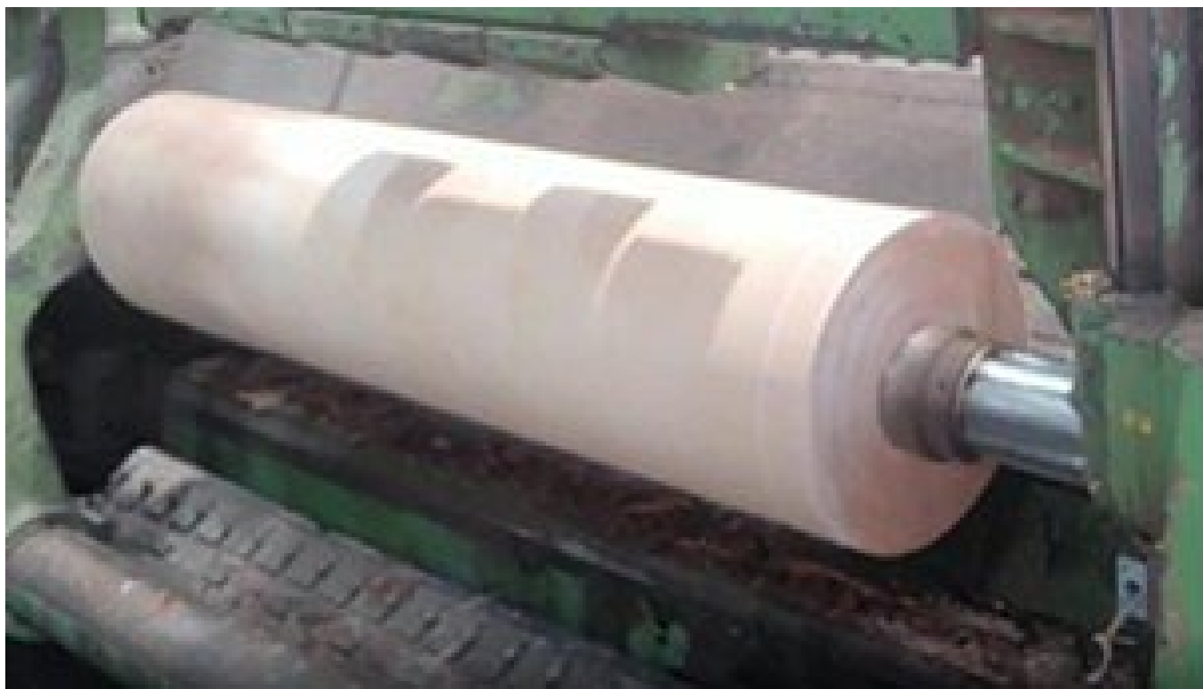
Slika 3: Hlod, pripravljen na luščenje.
