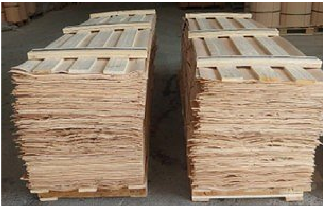
Slika 1: Furnir bukve, uporabljen za izdelavo slojnatega furnirnega lesa.
