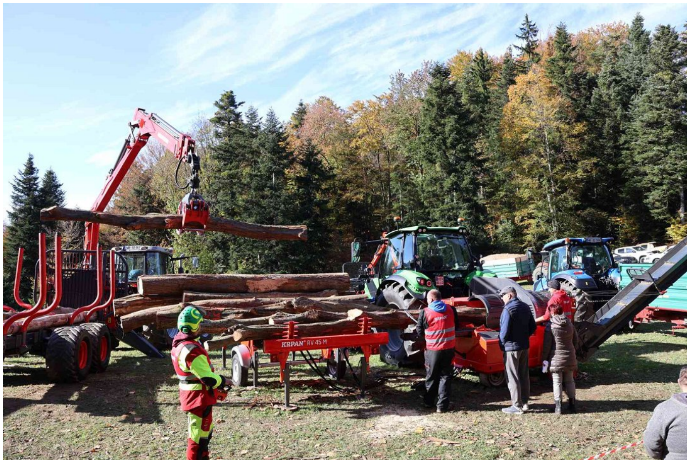
Slika 5: Rezalno-cepilni stroj s krožnim žagalnim listom in verižno rampo. Gozdarsko dvigalo uporabnik krmili daljinsko. Daljinsko krmiljenje je dodatna oprema in deluje kombinirano s krmilnimi ročicami na prikolici.
