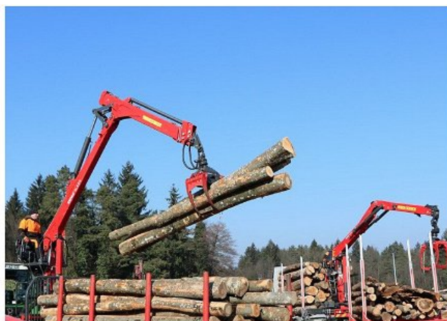
Pri Vitlih Krpan nudijo široko paleto gozdarskih prikolic z gozdarskimi dvigali in kamionska gozdarska dvigala. Slednje kupcu namestijo na zeleni tovornjak in ga opremijo z vso potrebno opremo za prevoz lesa.
