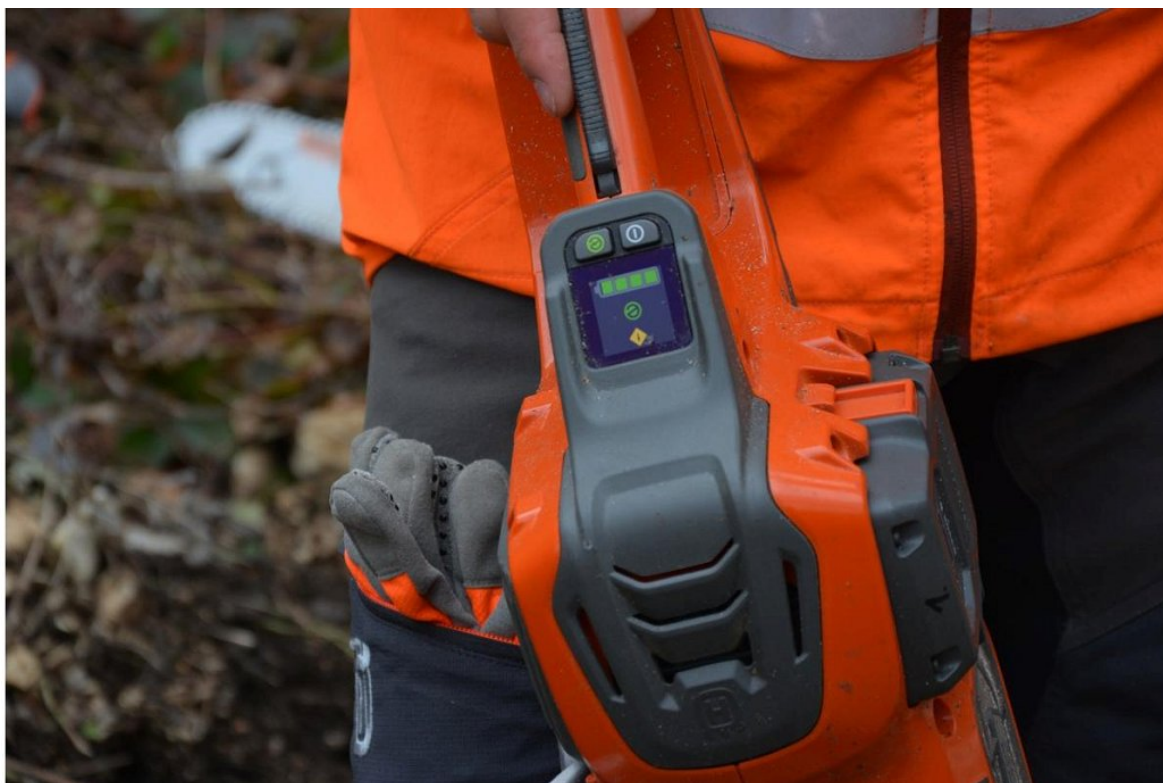
Slika 7: Nova baterijska žaga 550i XP ima sodoben zaslon, ki prikazuje tudi nivo verižnega olja.
