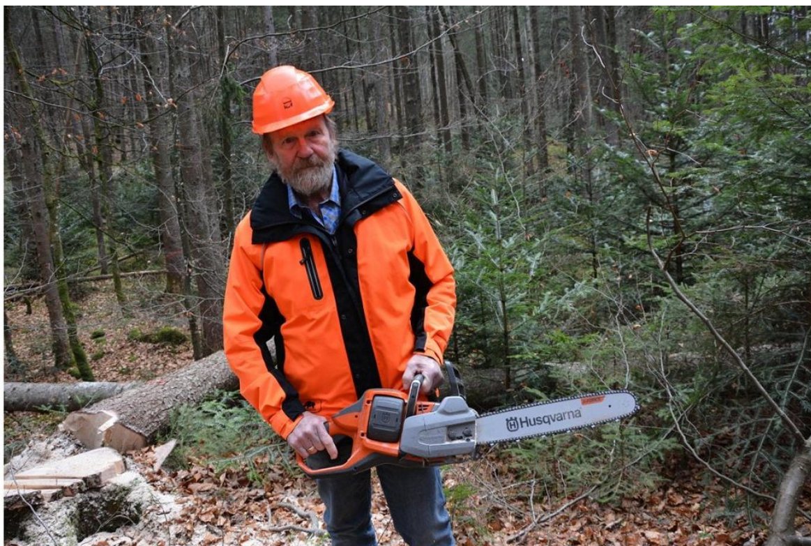
Slika 5: Nova baterijska žaga Husqvarna 550i XP je zasnovana za meče dolžine od 13 do 20 col (33 do 51 cm).
