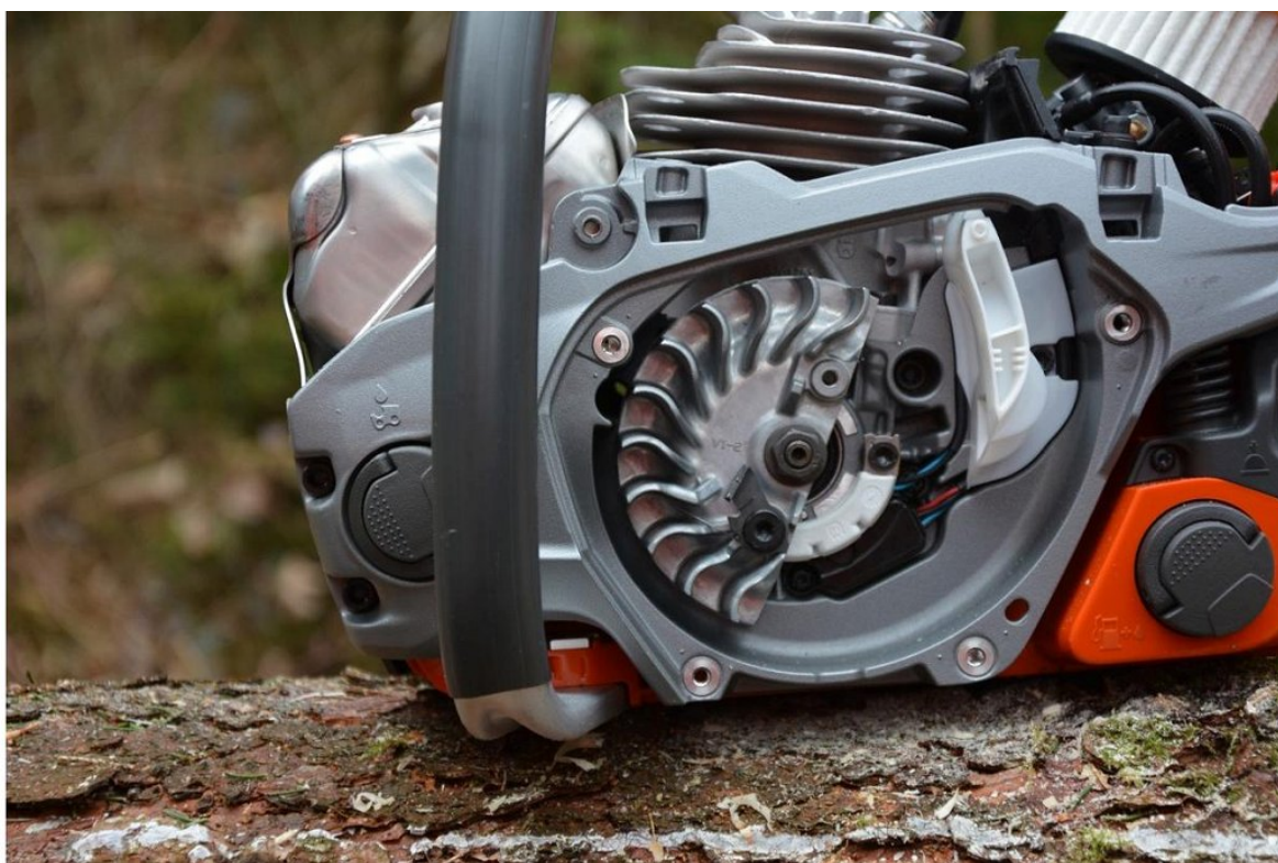
Slika 4: Prečni prerez hladilnega sistema 564 XP.
