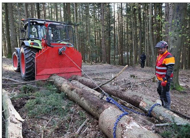
Vitli serije DH PRO so opremljeni z zobniškim pogonom in zagotavljajo konstantno vlečno silo. V enobobenski izvedbi jih nudijo z vlečno maso od 6,5 do 8,5 tone, na voljo pa tudi dvobobenske izvedbe. O teh si lahko več preberete v članku z razstave Forstlive v tej številki revije.
