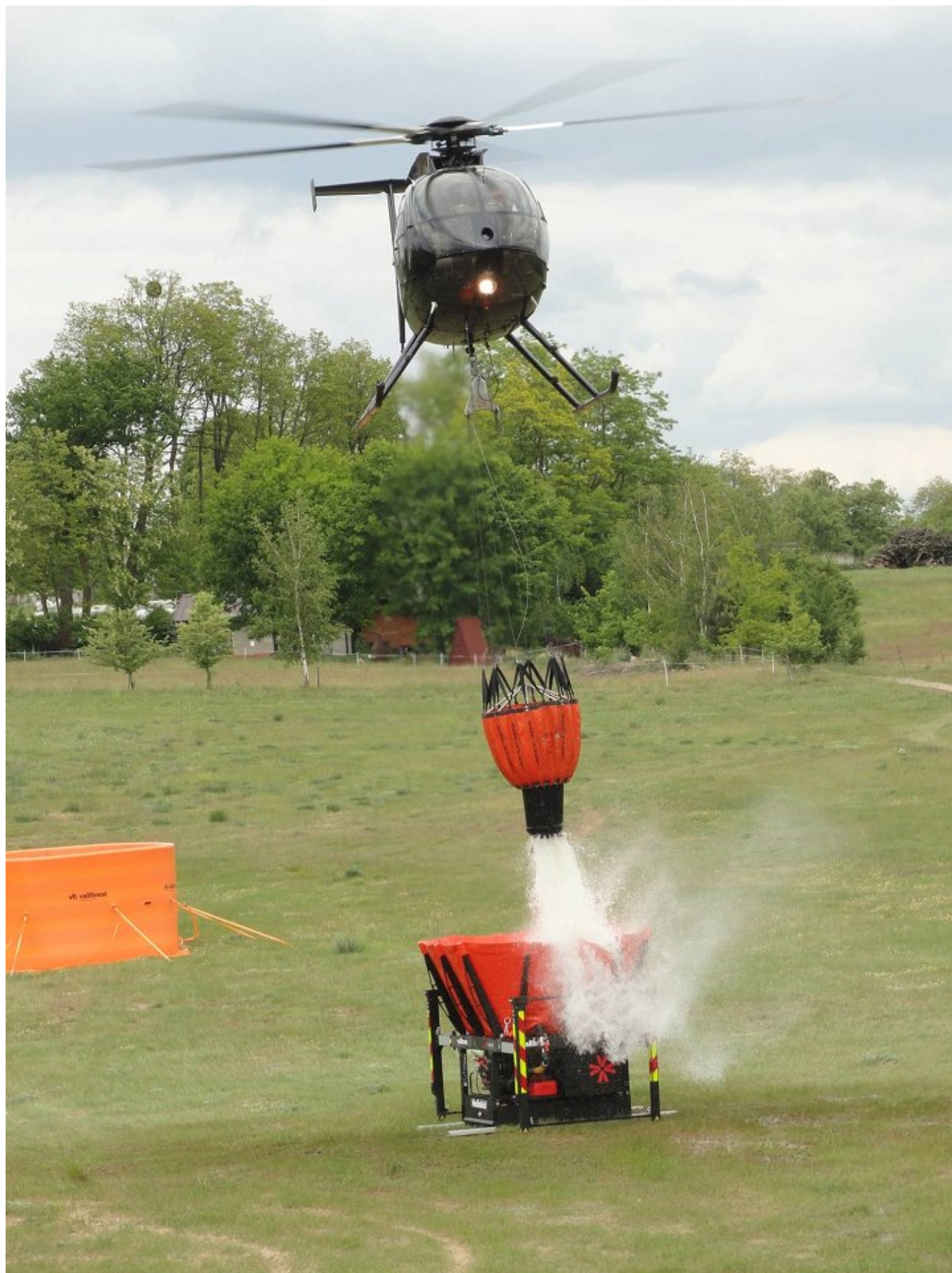
Slika 4: polnjenje »Heliskid« enote s helikopterjem je bilo v danih vetrovnih razmerah kar zahtevno opravilo (Foto: J. Saražin)
