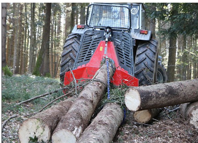
V podjetju Pišek – Vitli Krpan so gozdarski vitli njihov tradicionalni in še vedno vodilni izdelki. Nove vitle z verižnim pogonom nudijo z mehanskim ali elektrohidravličnim krmiljenjem (na sliki) in z vlečno maso od 3,5 do 9,5 ton. Tudi mehansko krmiljene vitla odlikuje proporcionalno krmiljena zavora.
