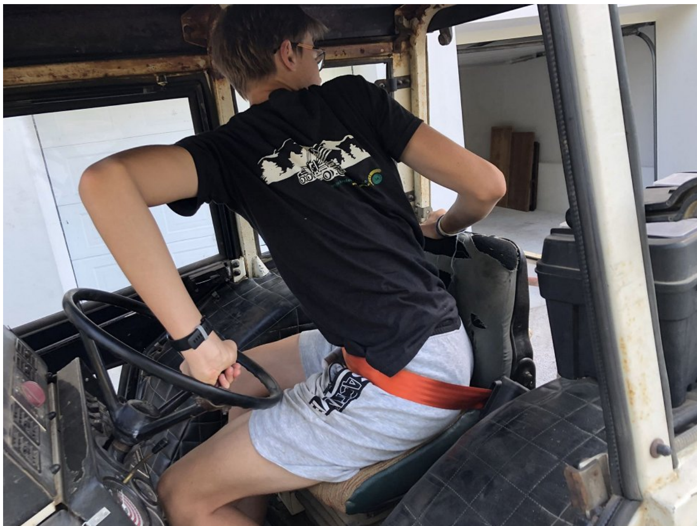
Slika 2: Za vgradnjo varnostnega pasu na starejši traktor ni nikoli prepozno, priporočamo pa, da izberete ELR tip varnostnega pasu. Ta pas z angleško oznako Emergency Locking Retractor se zapahne le, kadar je potrebno (npr. pri nagibu/prevrnitvi ali pri nenadni zaustavitvi vozila/nezgodi), sicer pa se njegova dolžina stalno prilagaja premikanju voznika. Npr. ko se voznik obrne nazaj oziroma tako kot pri osebnih avtomobilih. Foto M. Dolenšek.
