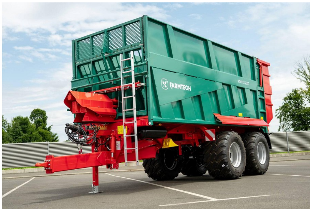
Slika 2: Potisno steno premika potisni mehanizem z dvema ali tremi potisnimi hidravličnimi valji, nameščenimi na sprednji strani prikolice. Notranjost tovarnega prostora je povsem gladka, kar omogoča enostavno in učinkovito čiščenje. Na sliki vidimo tudi hidro pnevmatsko vzmetenje vlečnega oja s spodnjim kroglastim priklopom.
