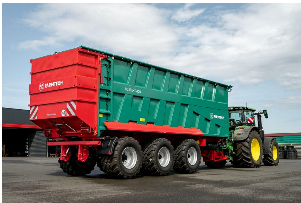
Slika 3: Fotex 3400 je najzmogljivejši model nove generacije Farmtechovih prikolic s potisno steno in ima tridem podvozje
