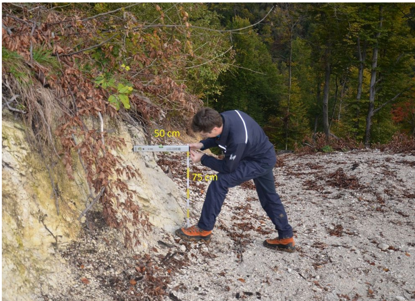
Slika 5: Primer merjenja naklona odkopne brežine z libelo in metrom. Na sliki je prikazan naklon odkopne brežine 75 \text{ cm} / 50 \text{ cm} = 150 \% , oz. običajno v elaboratu vlake zapisano kot 3:2
