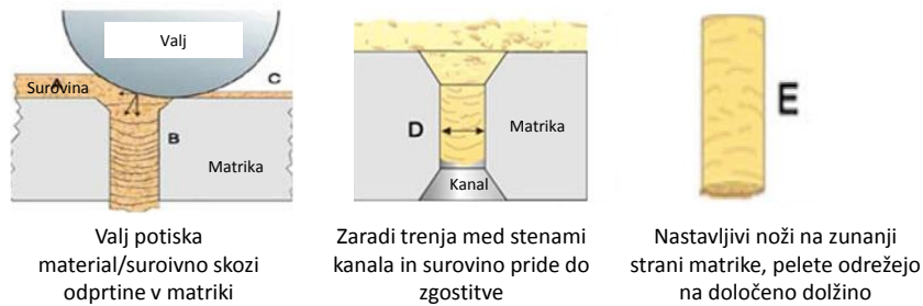
Slika 3: Mehanizem nastanka pelet.
