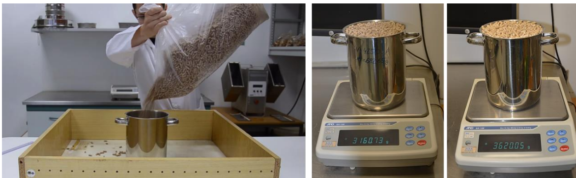
Slika 3: Posoda za določanje goste nasutja pelet, ter primerjava teže dveh različnih vzorcev pelet.
