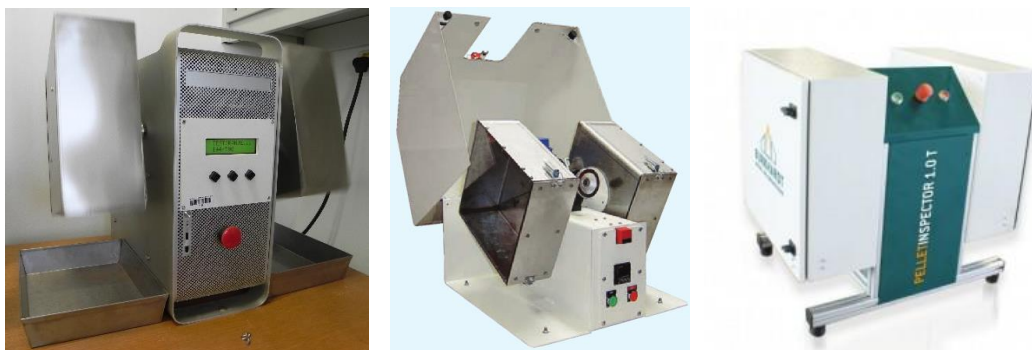
Slika 4: Izvedbe naprav za testiranje mehanske obstojnosti pelet sestavljenih v skladu s standardom SIST EN ISO 17831-1.
