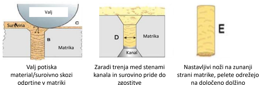
Slika 11: Mehanizem nastanka pelet.
