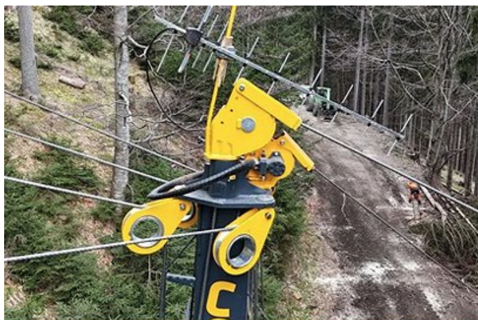
Škripci sidrnih vrvi, škripec nosilke in hidravlično gnani škripec vlačilke, ki skrbi za stalno napetost vrvi med bobnom vlačilke in škripcem. Antena na vrhu stolpa skrbi za radijski sprejem signala daljinskega krmilnika.
