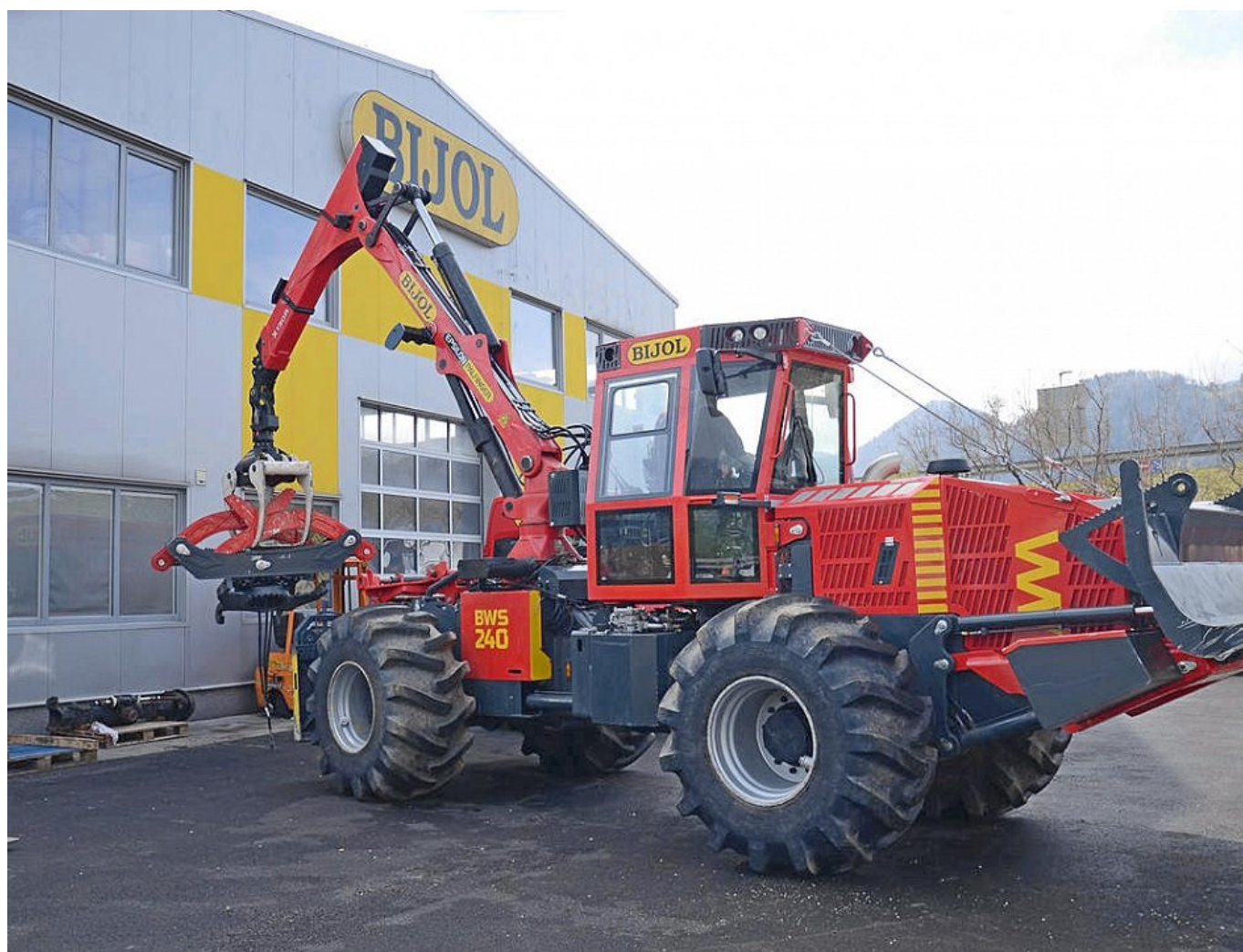
Slika 1: gozdarski zgibnik BWS 240 med nameščanjem klešč
