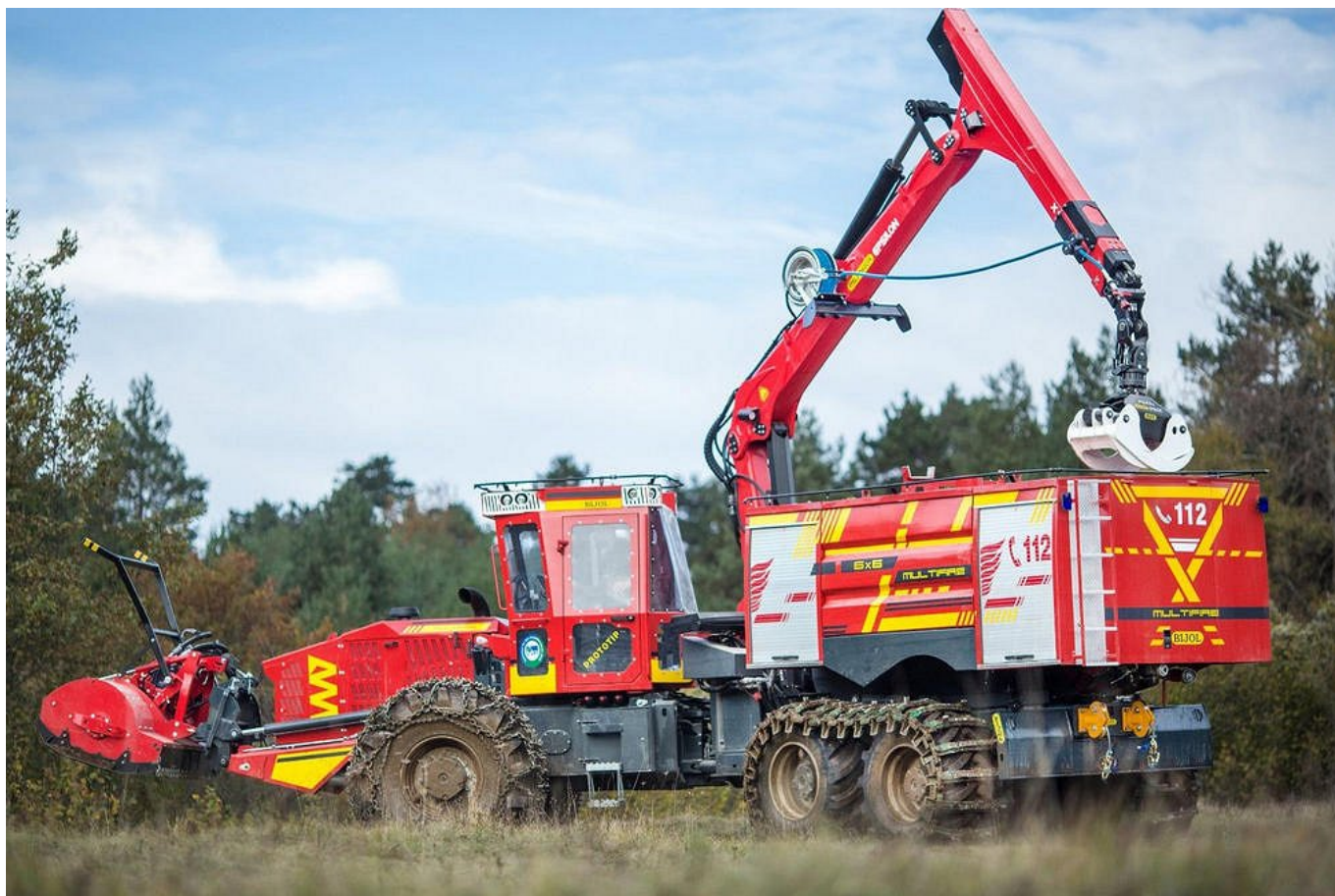
Slika 3: Forwarder MFT 240 z gasilsko nadgradnjo (foto www.bijol.eu )
