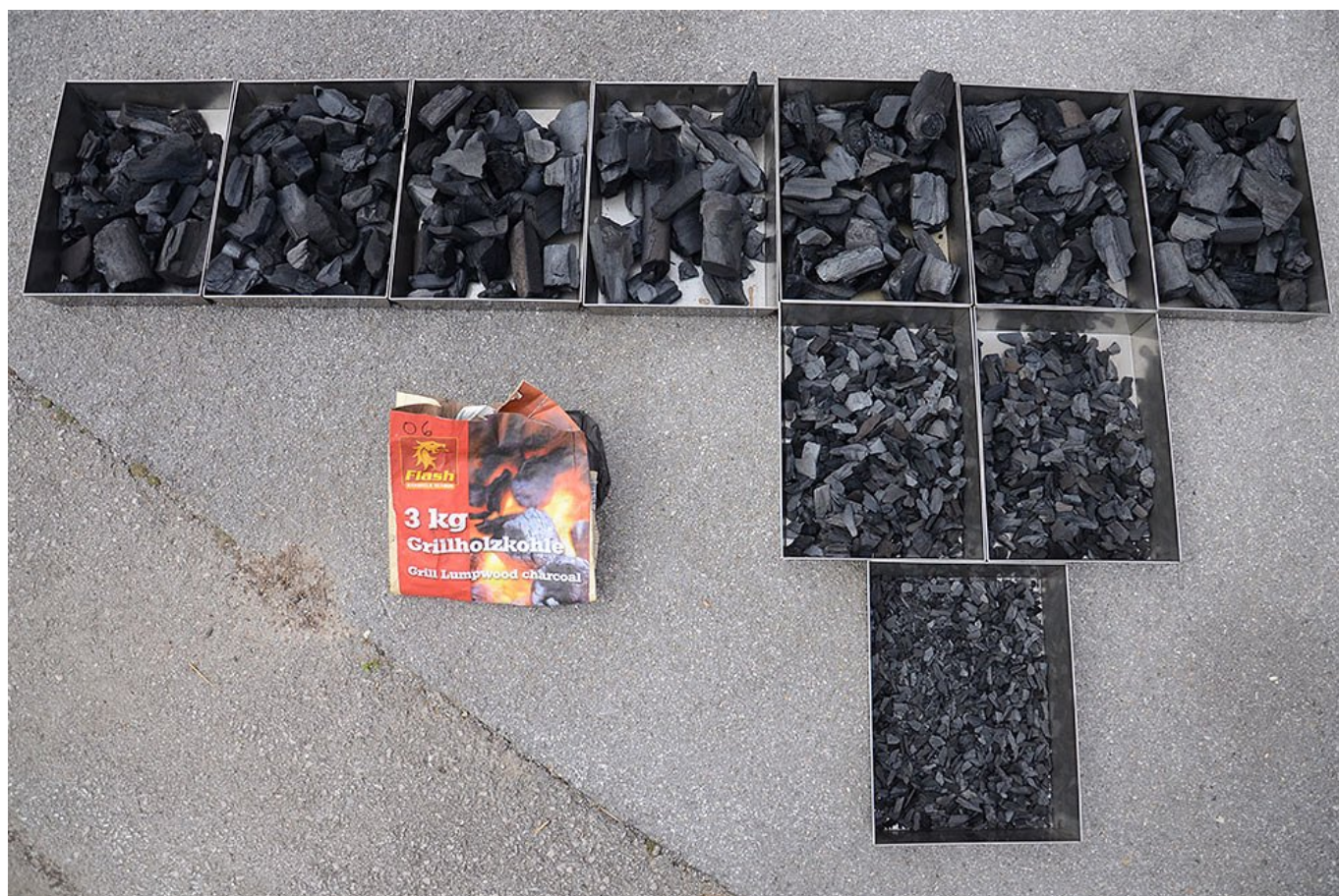
Slika 3: Razporeditev delcev po posamezni frakciji (20-80 mm; 10-20 mm;
