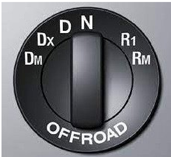
Slika 2: Gumb za izbiro prestavnega programa (Vir: www.man.eu )
