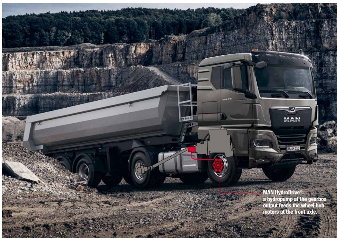
Slika 1: Tovornjak s hidrostatsko gnano prednjo osjo (Vir: www.man.eu )
