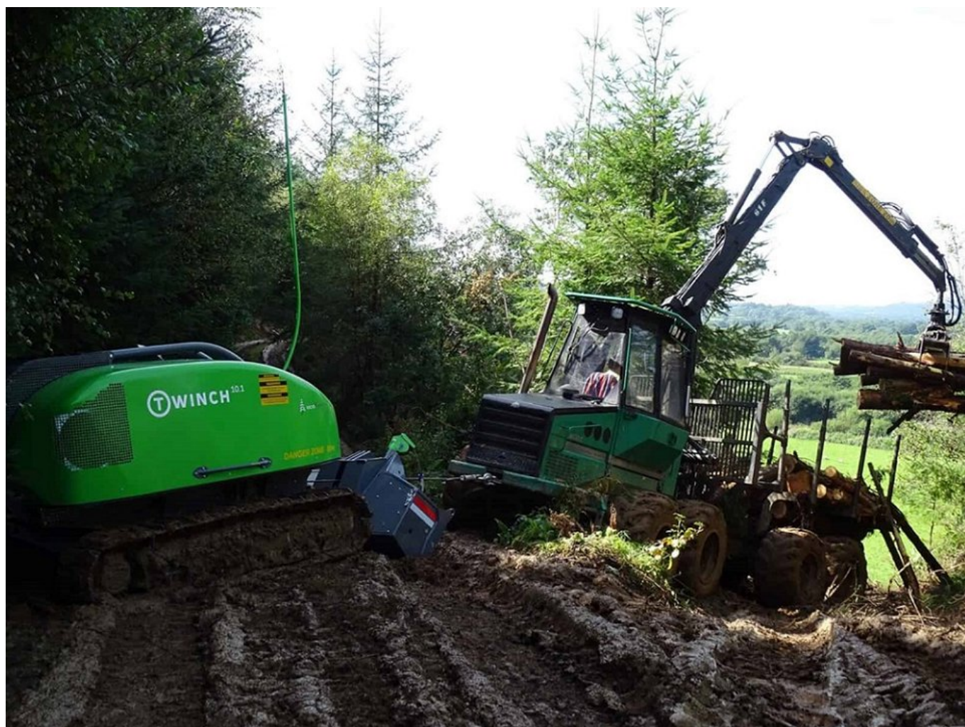
Slika 2: T-Winch kot predstavnik dinamičnega sistema WAF (Ecoforst, 2021)
