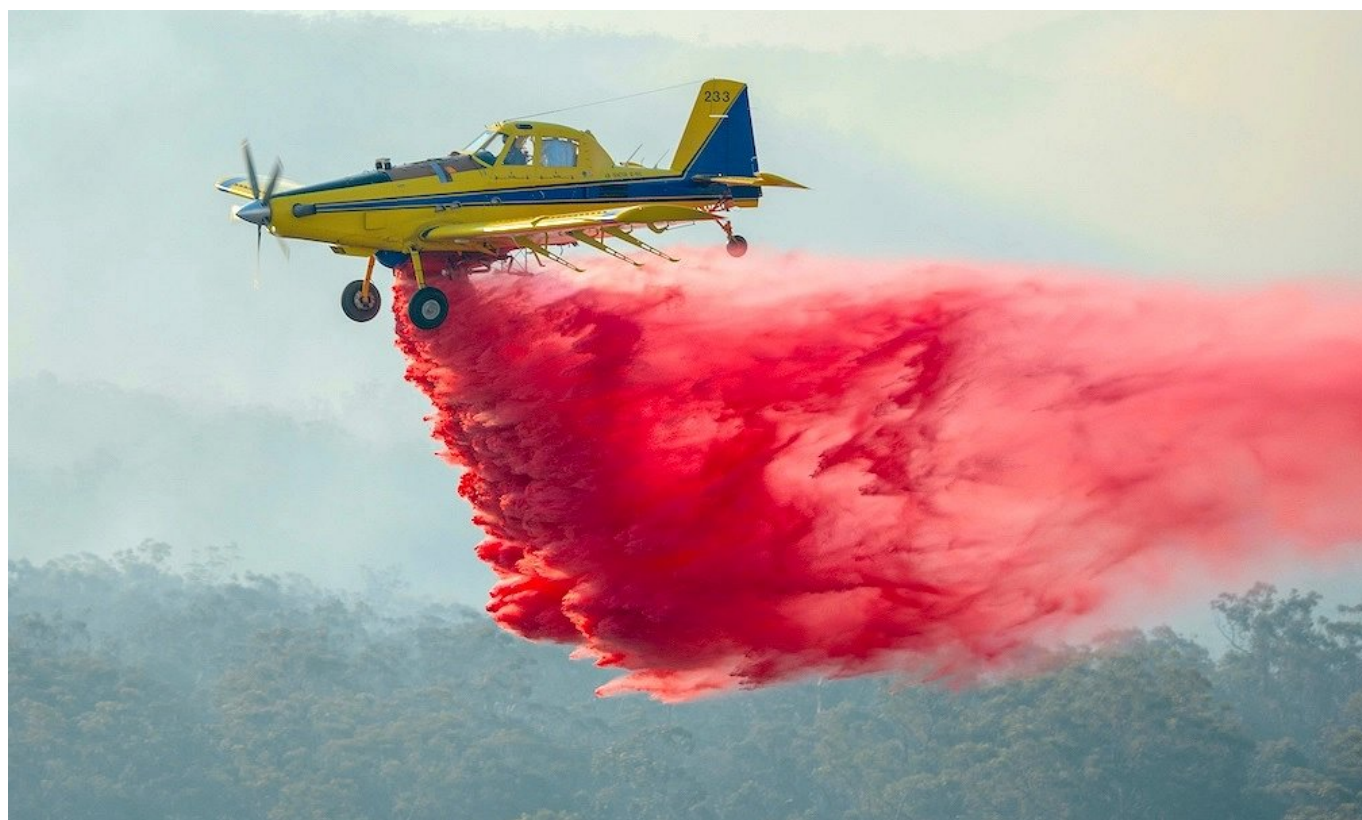
Slika 1: Air Tractor AT-802F med izpustom vode obarvane z retardantom (Air Tractor, 2022)
