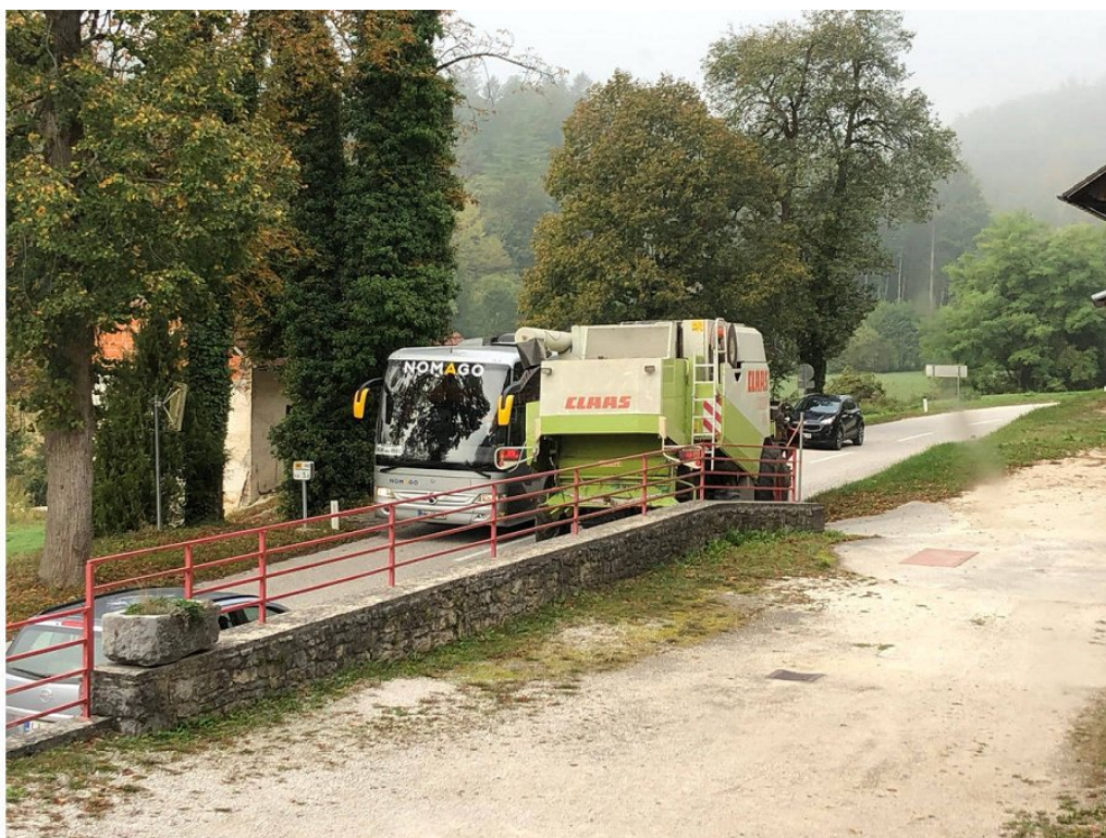
Slika 1: Splošna največja dovoljena širina vozil v cestnem prometu je 2,55 m, za kmetijska in gozdarska vozila na gospodarski vožnji pa 3,06 m. Za vse prevoze nad tem je potrebno dovoljenje za izredni prevoz.
