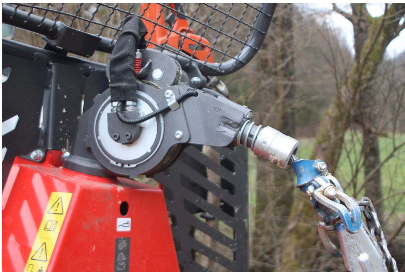
Slika 2: Novi izvlečni škripec. Kompaktna izvedba z notranjim pogonskim hidravličnim motorjem, novima pritisknima kolescema za vrv, ki sta preko ohišja povezana z usmerjevalnim vodilom za vrv na koncu katerega je nameščena vzdolžno gibljiva puša, ki pritiska na končno / izklopno stikalo za prekinitev vleke vrvi.
