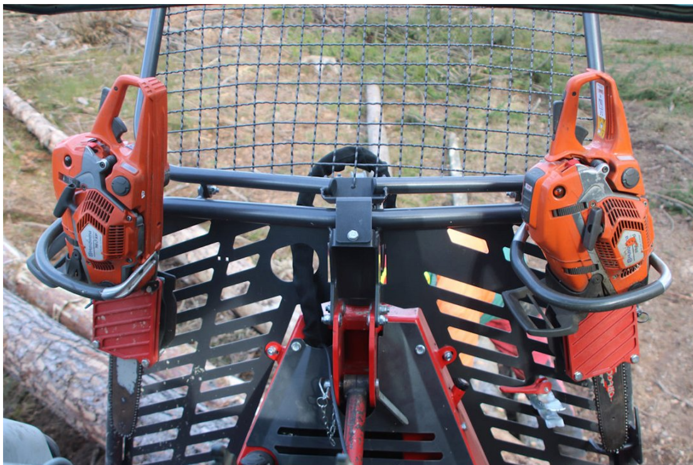
Slika 5: Novi nosilnik za motorno žago pri nameščanju ali izvleki žage lahko preklopimo za 90 stopinj iz pokončnega v vodoravni položaj. Standardno je nameščen en nosilec, dodatni je opsijski. V tem primeru moramo nosilnik za posodo za gorivo iz sprednje strani varovalne pločevine premestiti na zadnjo stran.
