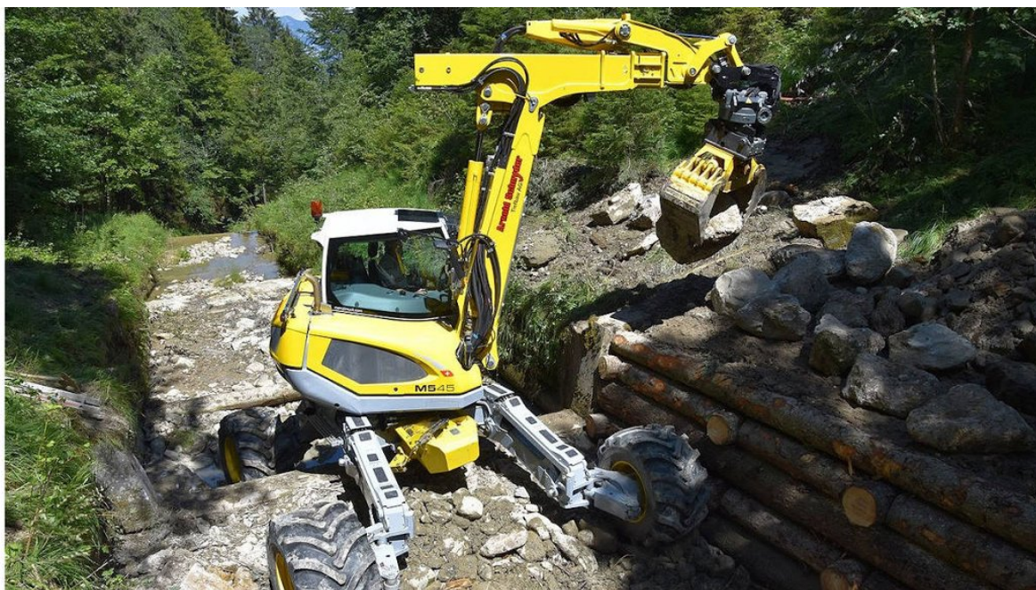
Slika 6: 13 tonski »pajek« kopač prilagojen za delo v strmih terenih (vir: www.menzimuck.com ). Nanj je možno namestiti tudi procesorsko glavo za izvajanje strojne sečnje ter ga dodatno zavarovati z »winched-assisted« sistemom.
