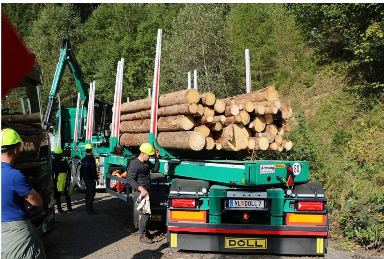
Slika 8: Novi pristopi pri kamionskem transportu. Sedlasti polpriklopnik z dvema krmiljenima premama zadaj in pomičnim nakladalnim prostorom – zgledi iz Severne Amerike, a prilagojeni na Evropo (foto M. Dolenšek).
