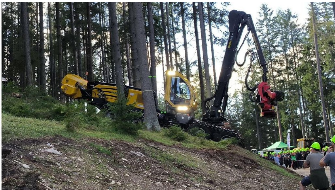
Slika 17: Nekateri proizvajalci (primer na fotografiji HSM-Hohenloher Spezial-Maschinenbau GmbH) uporabljajo podobno tehniko varovanja kot na slikah 15 in 16, le da je vitel tu kot priključek nameščen direktno na zadnjem delu stroja za sečnjo (foto: M. Jež).
