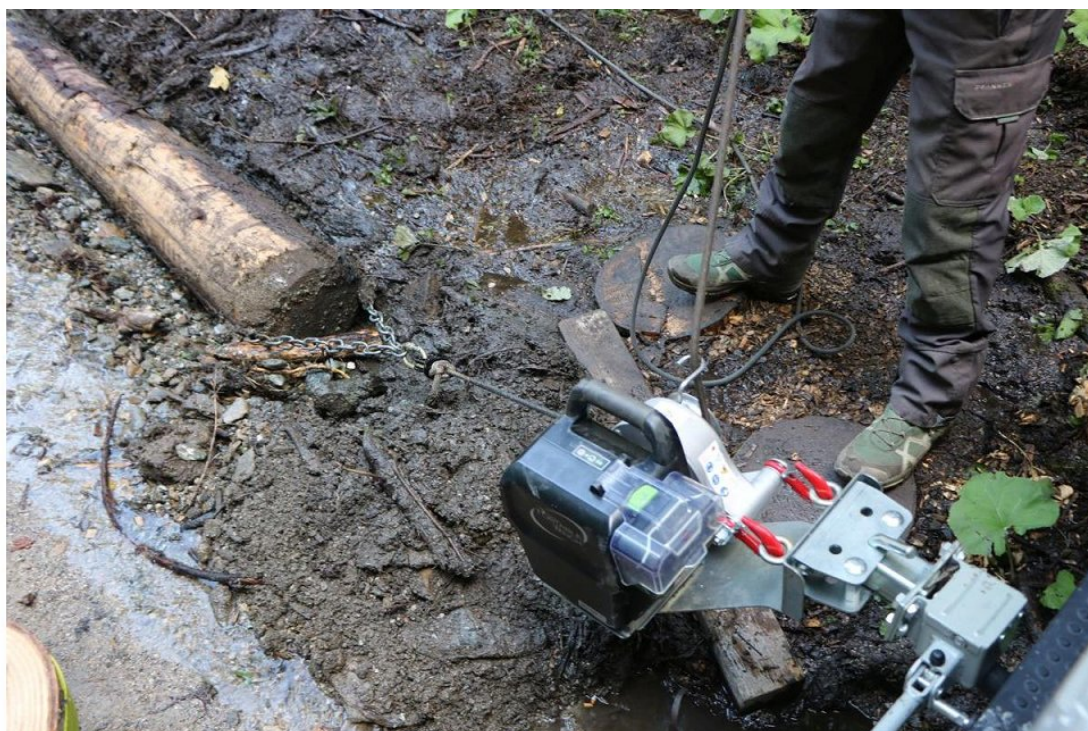
Slika 22: Kanadski mali vitel s tornim kolesom z namenskim elektromotorjem in baterijo zmogljivosti 216 Wh, kar odgovarja cca. 2 dl dizelskega goriva, a ne smemo pozabiti, da imajo elektromotorji veliko boljši izkoristek energije kot motorji z notranjim izgorevanjem (foto M. Dolenšek).
