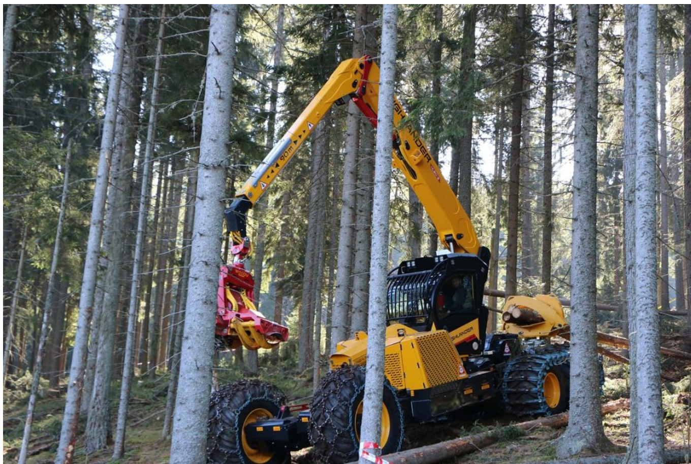
Slika 18: Na razstavnem prostoru podjetja Konrad Forsttechnik GmbH smo poleg žičnega žerjava na kamionu lahko pri delu videli kombiniran stroj za ekstremne terene Highlander HL20-2. Sprednji kolesi sta posamično vpeti v teleskopska nosilna profila, ki se lahko spuščata navzgor in navzdol in tako kolesi prilagajata terenu. Stroj dela kot harvester in/ali kot gozdarski traktor za izvleko lesa na prijemalnih kleščah (foto M. Dolenshek).
