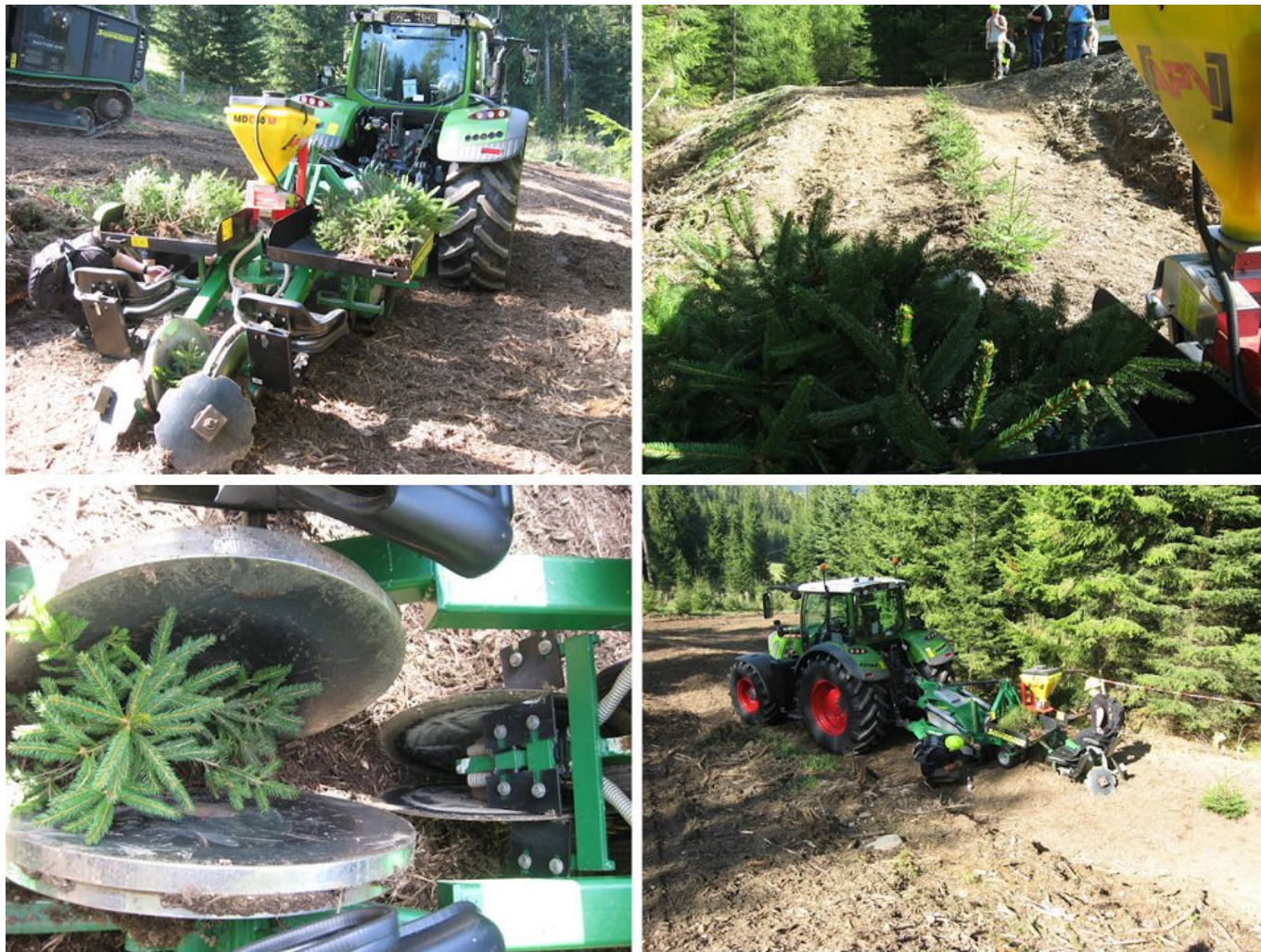
Slika 23: Metoda strojnega sajenja drevesnih sadik (foto: P. Smolnikar).
