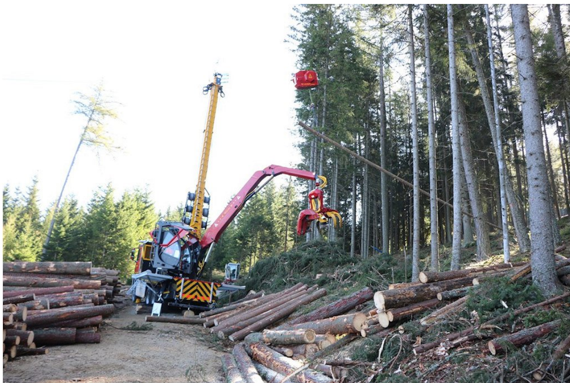
Slika 10: Klasični stolpni žični žerjav z dvosmerno vleko vozička in žerjavnim dvigalom s harvestersko glavo Woody (foto M. Dolenšek).
