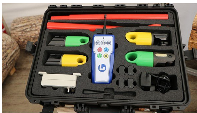
Daljinsko kontrolirana oprema za vezanje (čoker) podjetja Ludwig System GmbH & Co. KG (M. Dolenšek).
