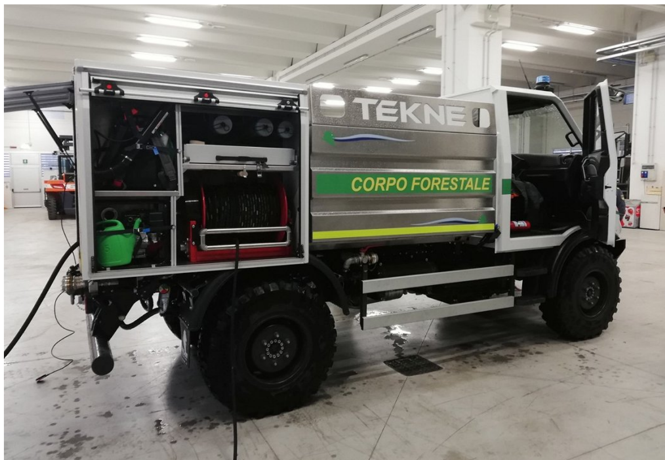
Slika 1: vozilo, ki smo si ga ogledali je v lasti gozdne policije iz Tolmezza. Ima dva visokotlačna navijaka, 3000 litrski rezervoar za vodo ter ostalo opremo za gašenje gozdnih požarov.
