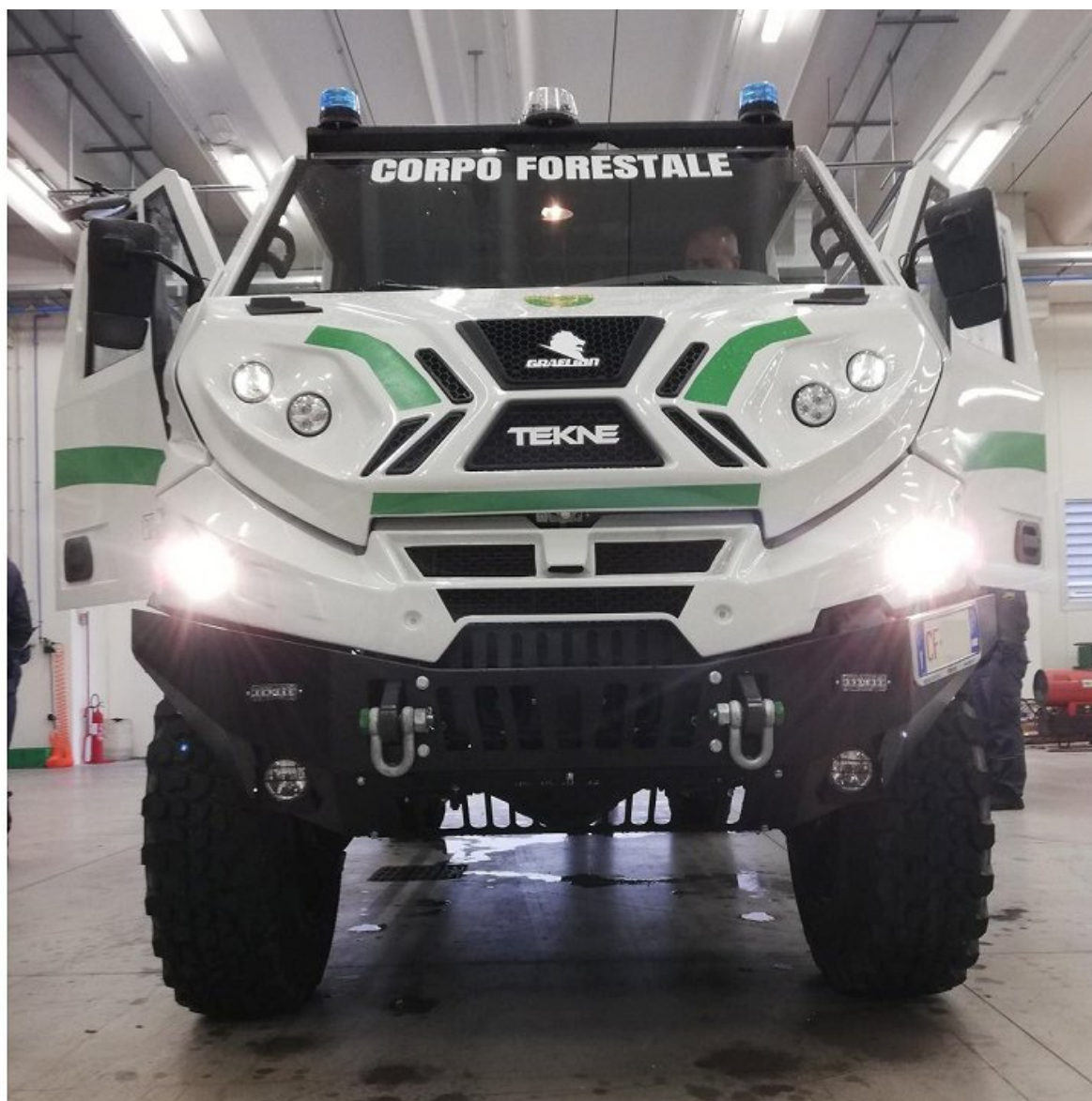
Slika 2: Graelion 75 se lahko pohvali s 45 cm prehodnosti (clearance) ter robustnim podvozjem
