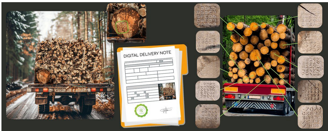
Slika 2: Ob prvi pošiljki iz gozda se ustvari digitalni dobavni list, ki vsebuje logistične podatke, podatke o vozilih, GPS poročilo in fotografsko dokumentacijo. Unikatna koda je označena na čelih sortimentov (vir slike: Deeplai.com, 2024).
